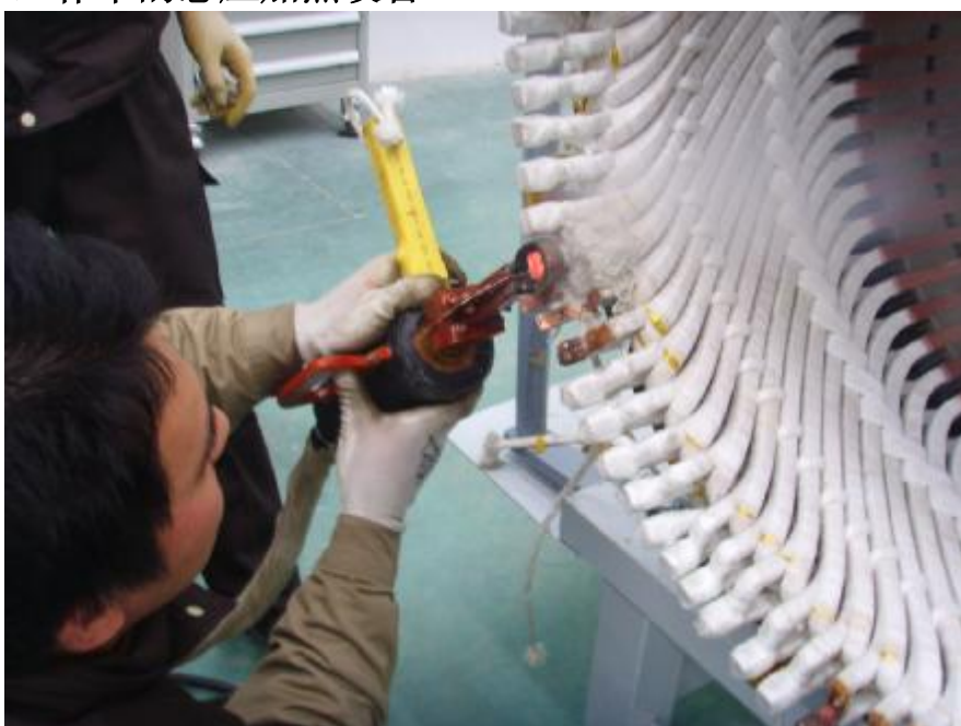
手持变压器焊接定子接头
